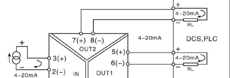
注意: 若有一路输出通道闲置不用时, 必须把闲置的输出端子用导线短接, 否则另外一路不能正常输出。
